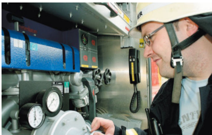
Der Druck muss stimmen: Martin Kröger ist Maschinist bei der Feuerwehr Steinheim und sorgt dafür, dass das Wasser mit genügend Druck zum Feuer gefördert wird. Maximum sind dabei acht Bar.
